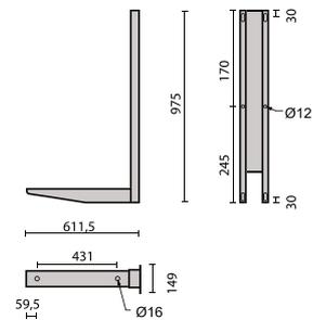
Suportes de parede - AAS(PAR) - 120L e 200L
